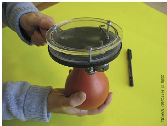
Figura 4: Una versione modificata della camera di Wilson è stata ideata da Schurholz. Nella variante semplificata di Schurholz, l'espansione della camera a nebbia è provocata manualmente agendo con una piccola pompa (Foto: V. Napoli).
