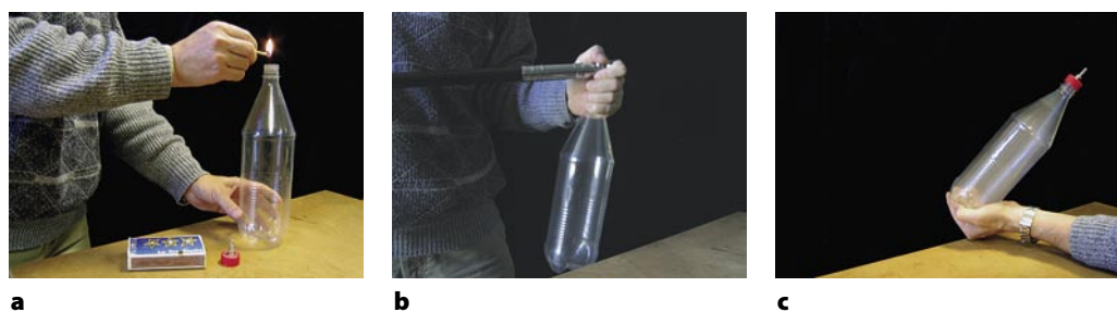
Figura 7 a, b, c: Come creare una nuvola in bottiglia. Si inserisce un fiammifero appena spento nella bottiglia. Questa viene poi chiusa con un tappo su cui è applicata una valvola per camera ad aria di bicicletta. Con una pompa si immette dell'aria nella bottiglia. La brusca espansione dell'aria provocata dal rapido svitamento del tappo causa l'abbassamento di temperatura e la condensazione del vapor acqueo sui corpuscoli di fumo (foto F. Logiurato).
