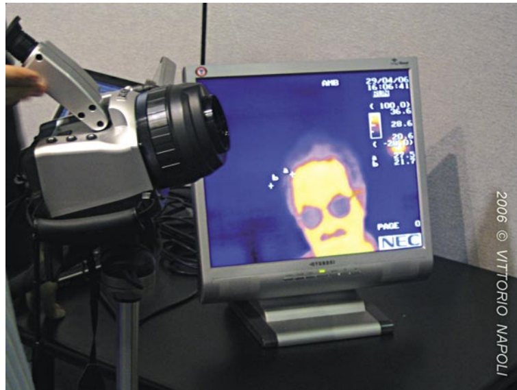
Figura 4: Il monitor (a destra) visualizza il volto di una persona ripresa con una telecamera a raggi infrarossi (a sinistra). Il colore blu ha una "temperatura" inferiore a quella del colore giallo (Foto: V. Napoli).
