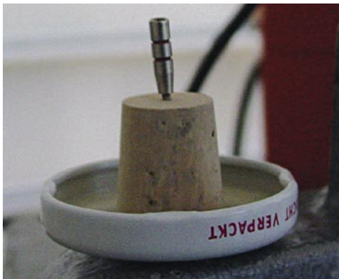
Figura 11: Sorgente radioattiva utilizzata (Ra 226 – attività 3.3 k Bq) (foto: L. Bazzanella, A. Cristofori).
