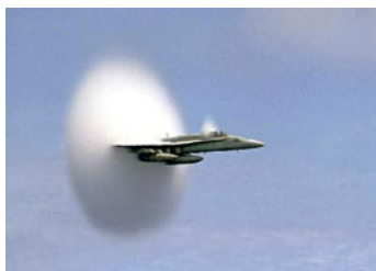
Figura 5: Un aereo militare nell'istante in cui supera la barriera del suono. Particolari condizioni di bassa pressione e umidità, al momento della creazione dell'onda d'urto, provocano la condensazione del vapor acqueo (foto: Wikipedia).
