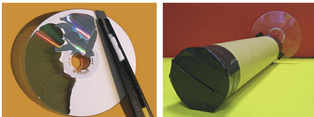
Figura 2: A sinistra è riprodotto un CD parzialmente sbucciato. La pellicola funziona come un reticolo di diffrazione in riflessione. A destra abbiamo uno spettroscopio in trasmissione costruito con un CD e un tubo di cartone. Il tubo è lungo circa 40cm, mentre la fessura all'estremità è di qualche millimetro. L'oculare dell'osservatore corrisponde al CD (foto F. Logiurato).
