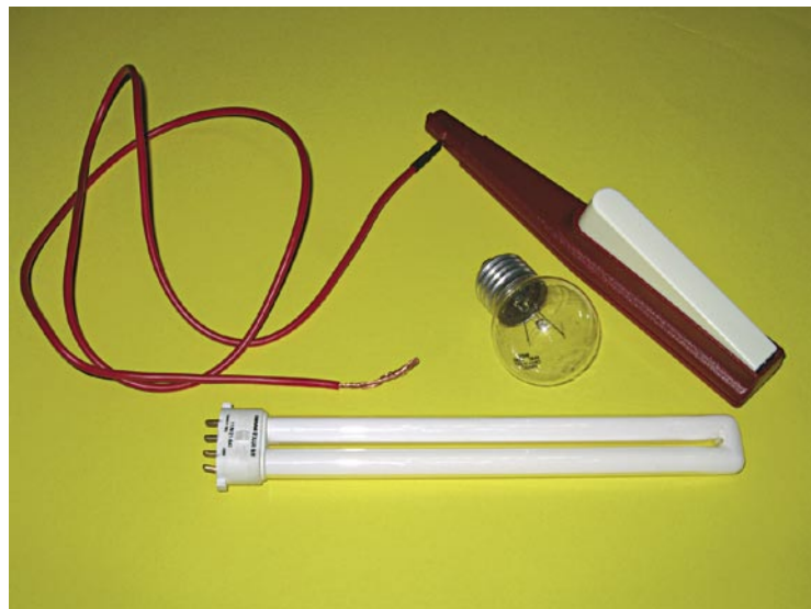
Figura 1: Con la tensione di un accendigas elettrico si possono creare scariche in una lampadina o in un tubo al neon. (Foto: F. Logiurato).
