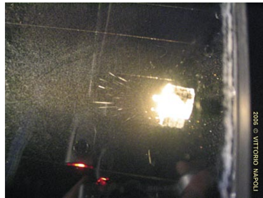
Figura 12: Tracce di particelle alfa e beta (Foto: V. Napoli).
