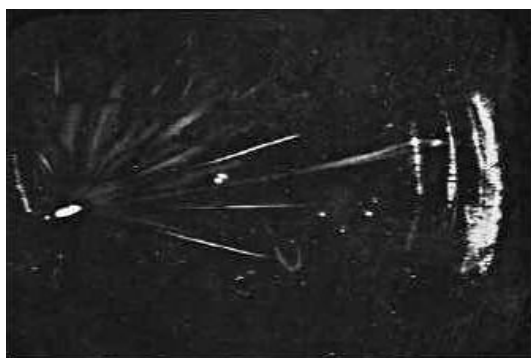
Figura 3: La prima fotografia scattata da Wilson. Il dispositivo che metteva in atto l'espansione era connesso ad un meccanismo che faceva scattare anche una macchina fotografica. Nella foto si osservano le tracce delle particelle \alpha e \beta emesse da una sorgente radioattiva di radio (la sorgente è la piccola macchia bianca a sinistra). La scia lasciata dalle particelle \beta è flebile, mentre le particelle \alpha lasciano una traccia molto più evidente.
