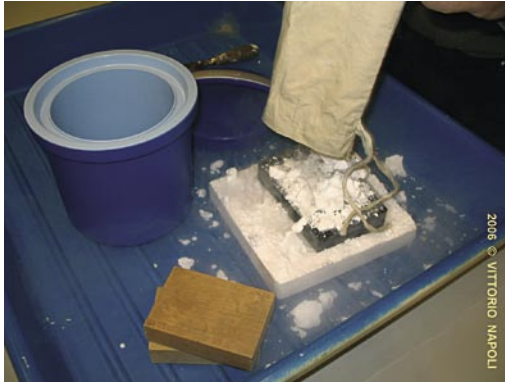
Figura 4: Si versa l'anidride carbonica sul supporto di polistirolo recante il magnete (Foto: V. Napoli).
