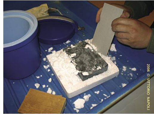
Figura 5: L'anidride carbonica viene compattata (Foto: V. Napoli).
