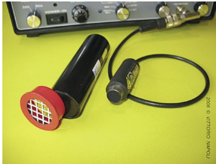
Figura 2: Due contatori Geiger, in primo piano sono visibili le finestre di mica che chiudono i rivelatori (Foto: V. Napoli).
