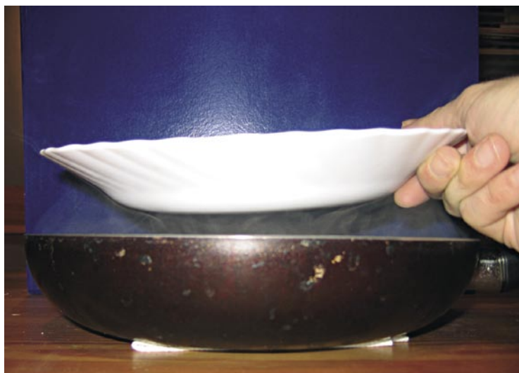
Figura 3: Nella foto la condensazione del vapor acqueo è molto meno evidente che ad occhio nudo. Se anche il piatto è stato in ghiacciaia, il vapore condensa principalmente sotto di esso. Sul fondo del piatto compaiono pian piano delle goccioline d'acqua che ricadono nella padella (piove!). (Foto: F. Logiurato)
