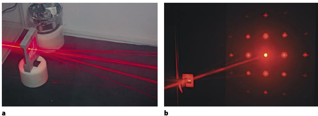
Figura 9: Diffrazione da un reticolo bidimensionale di un fascio laser di luce rossa. Uno schermo è disposto parallelamente al reticolo e ortogonalmente al fascio. Dall'analisi dello schema di diffrazione è possibile risalire alla particolare struttura del reticolo (foto Laboratorio di Comunicazione delle Scienze Fisiche).
